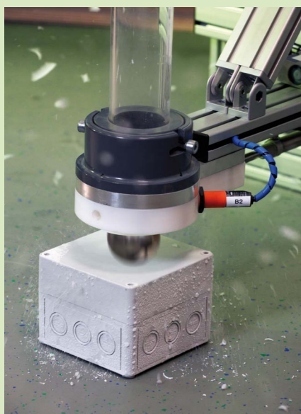
De splinters zijn ijsrestanten van het koelen tot -35 °C.
